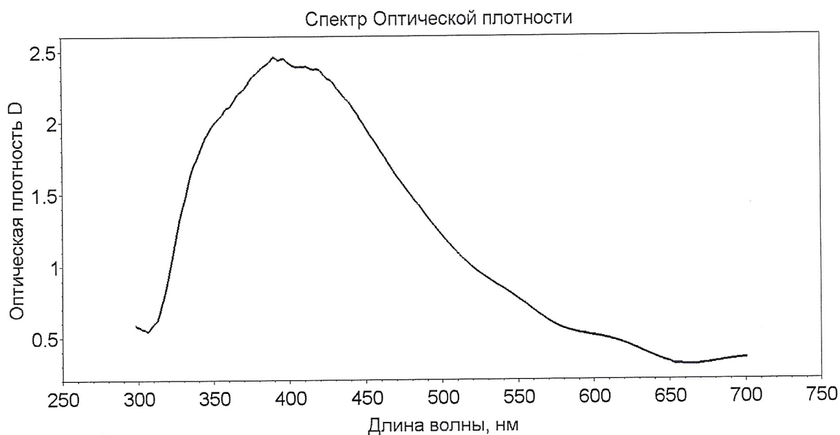
Рисунок 8– Экспериментальные данные спектра оптической плотности образца 4 пленки нитрида кремния с соотношением потоков 16/4 на кварцевой подложке
