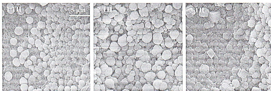
Рисунок 2 – СЭМ-изображения минерализованных \text{CaCO}_3 нановолокон с магнетитом, индуцированным методом копреципитации (три технологических цикла)
