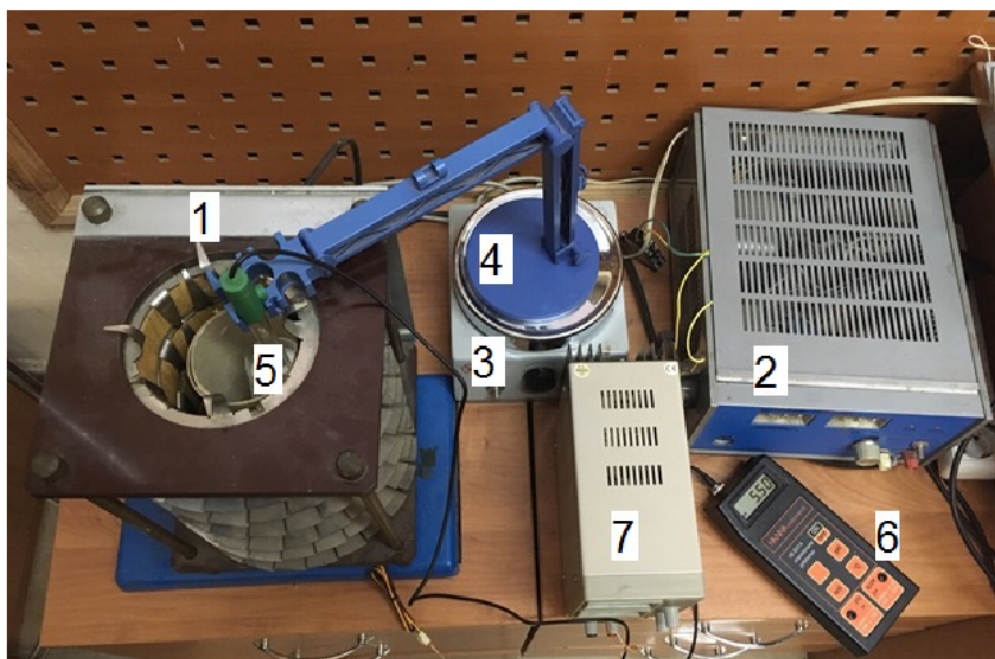
Рисунок 4. Экспериментальная установка: 1, 2 – источник ПМП, панель регулировки параметров ПМП; 3 – магнитная мешалка; 4 – штатив для крепления на нем измерительного электрода; 5 – кювета с раствором \text{H}_2\text{O}_2 и погружённым в неё измерительным электродом; 6 – прибор для регистрации показателя pH; 7 – блок питания pH-метра
