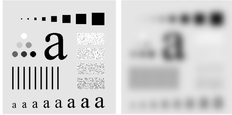
Рисунок 3.2 — Оригинал изображения (слева), изображение, к которому был применен низкочастотный фильтр Гаусса при r = 5 (справа)
