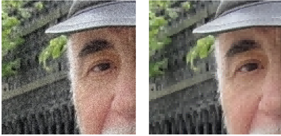
Рисунок 4.2 — изображение с равномерным шумом (слева), сглаженное изображение (справа)
